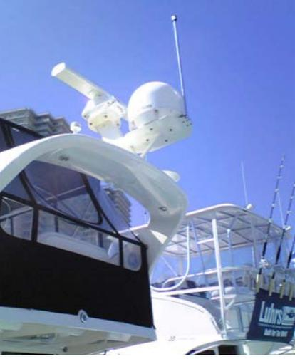
衛星デジタル放送受信対応。衛星を自動で追尾し、常に最良の受信状態を維持します。
